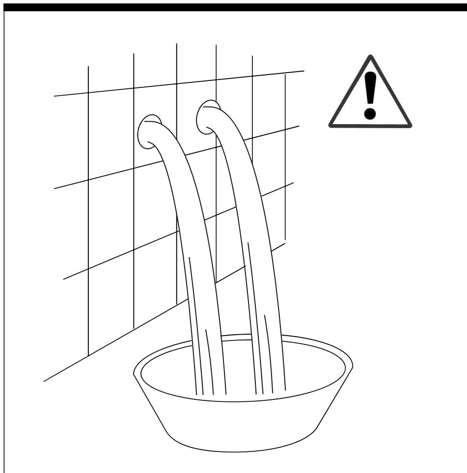
**IT** Si raccomanda prima di installare il prodotto di spurgare accuratamente i tubi di alimentazione.
